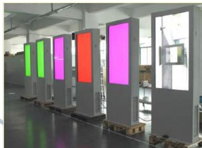
Test simulazione raggi solari ►
